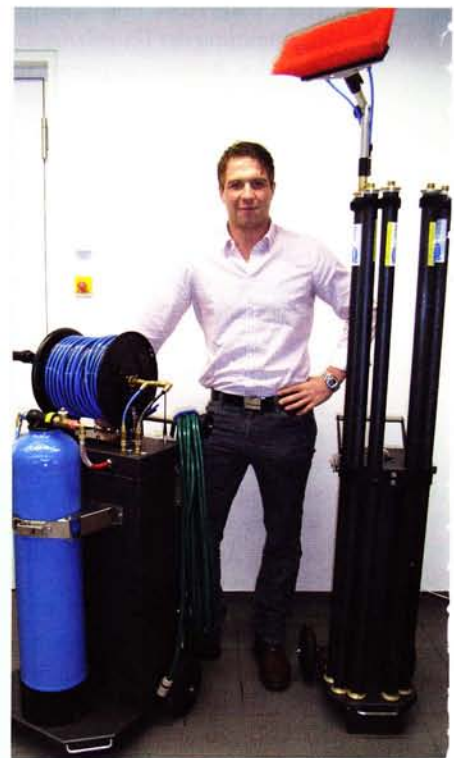
Das verwendete HI-REACH-Rohr aus Kohlefaser
